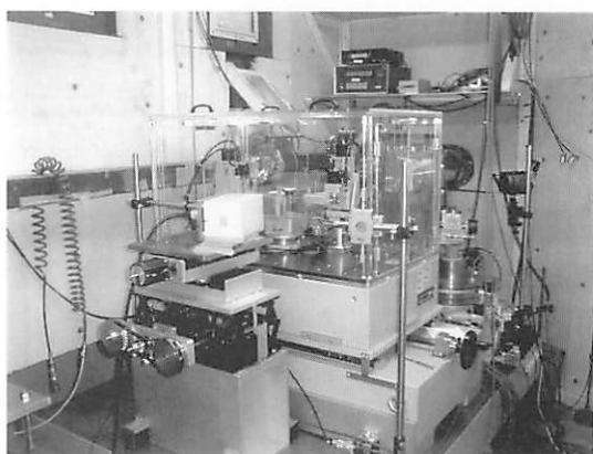
図 7 大型一体型X線干渉計システム
