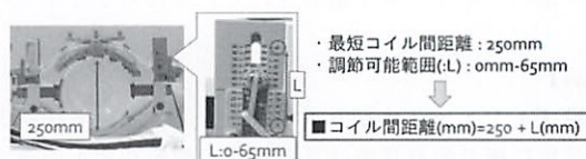
(図 1) コイル間距離の調整
