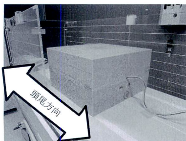
図 1 タフウォーターファントムの設置方法 (40cm×40cm×22cm)
